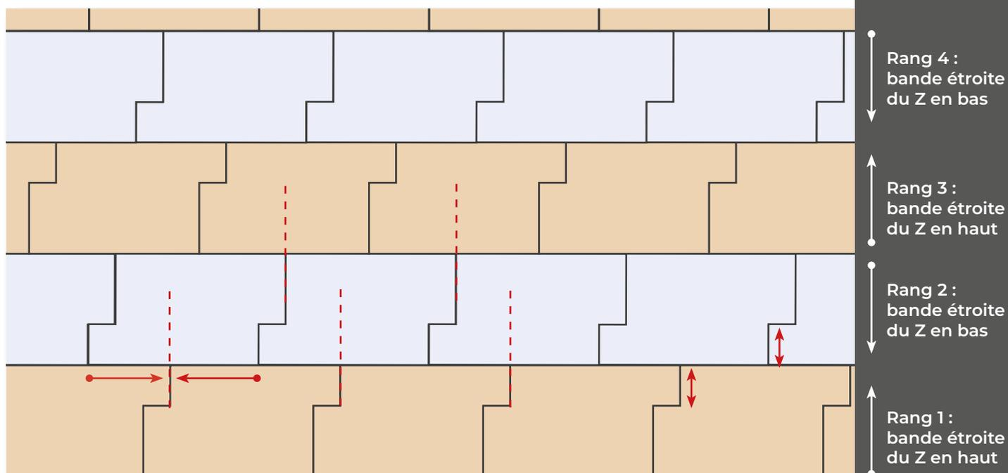
Le joint du rang inférieur croise à mi-distance des joints du rang supérieur
