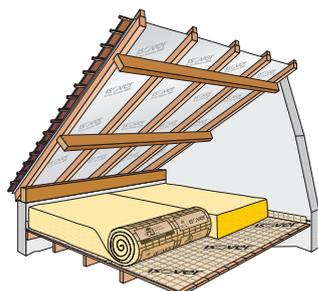
Isolation d'un comble perdu sur un plancher plat (bois, béton, terre cuite) qui sera condamné. Possibilité de rapporter un plancher bois par le dessus pour stockage avec mise en œuvre d'un pare-vapeur de type Stopvap entre le plancher et l'isolant.
