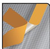
L'étanchéité à l'air à ce niveau est assuré par le collage du ruban adhésif universel centré sur le chevauchement. Les lés de pare vapeur doivent être suffisamment tendus et ne pas présenter de plis de manière à assurer une application homogène de la bande adhésive
